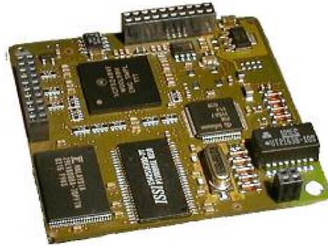
Universelles ISDN-Terminaladapter-Einbaumodul für POS-Terminals, Industriegeräte und andere Einsatzbereiche.
